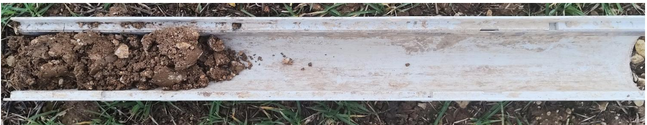
Photographie 6 - Carotte n°57 de sol non caractérisable (Classe NC)
